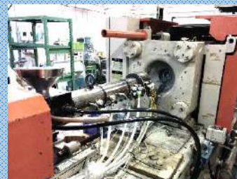
複雑形状金属製品の大量 生産が可能な金属粉末射 出成形(MIM)装置。
